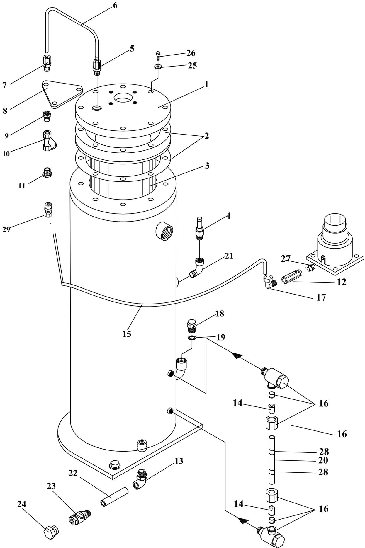
**KOMPRESÖR TAHLİYE ve SKAVENÇ HATTI / COMPRESSOR DISCHARGE SYSTEM /ENTLADUNG UND ÖLRÜCKLEITUNG**
